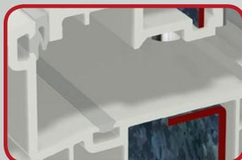
Le joint central dans le feuillure du dormant contribue largement à améliorer l'isolation thermique. En outre il protège les raccords contre l'humidité et conduit ainsi au meilleur comportement d'ouverture, surtout à basse température ambiante. Le S 9000 est optionnellement disponible en version joint frappe avec deux plans d'étanchéité
